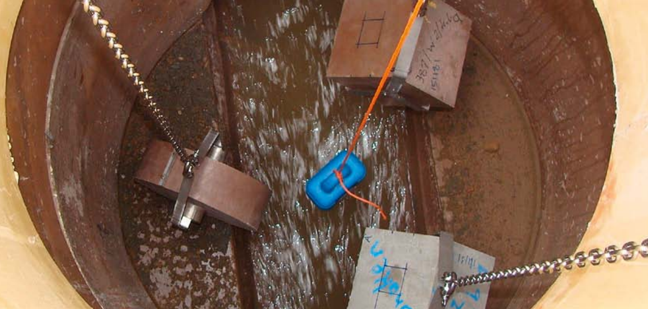
Afbeelding 1: Te monitoren stalen, opgehangen net boven de waterlijn.
